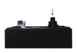
Descubrimos ahora la tapa de la caja reductora quitando los engranajes y sus respectivos ejes, para extraer el circuito pulsamos con cuidado en el eje del potenciómetro (flecha roja).
