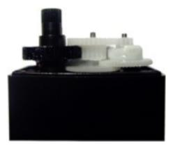
Volvemos a soldar el potenciómetro en su lugar y colocamos la electrónica en la caja del servo, colocamos las ruedas dentadas (ver imagen derecha) cerramos la caja reductora y atornillamos el servo y listo.
